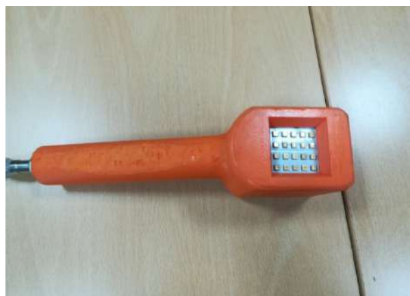
Слика 4 Прототип UVC LED стерилизатора, са извором светлости у виду UVC LED диода, при чему свака диода (на чипу их има 20) генерише светлост таласне дужине 275 nm.
