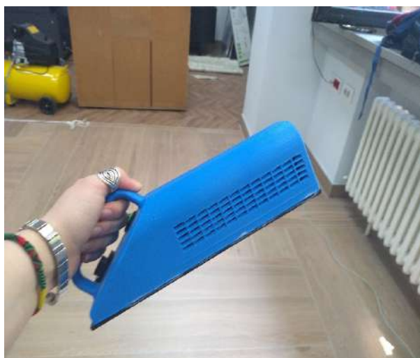
Слика 3 Прототип уређаја за стерилизацију површина и ваздуха са UVC лампом на бази живе (таласне дужине 245 nm)
